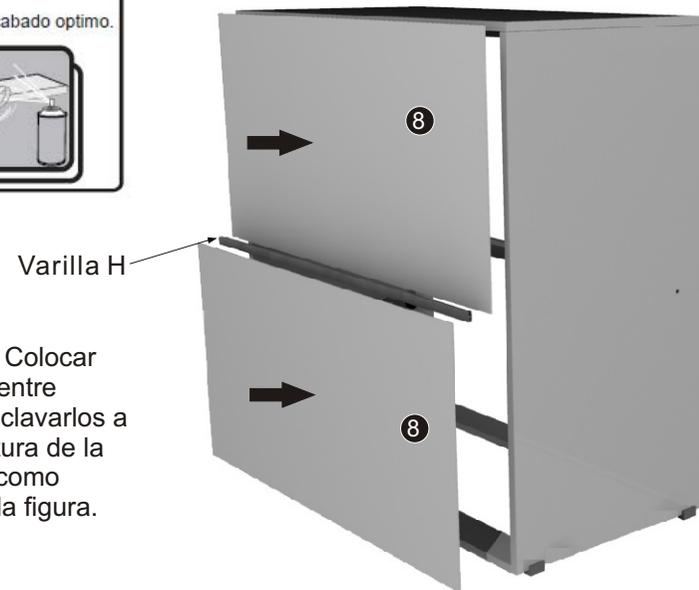
**PASO 4:** Colocar varilla H entre fondos y clavarlos a la estructura de la comoda como muestra la figura.
