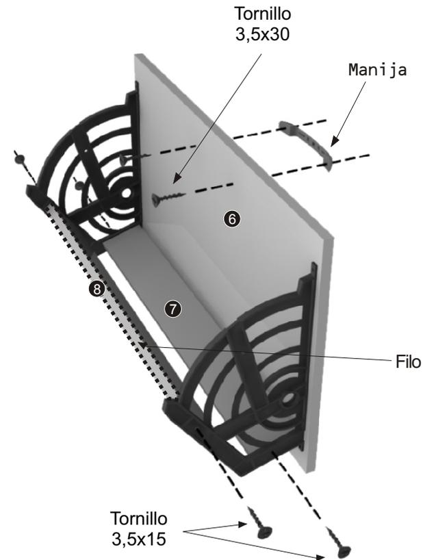
**PASO 5:** Colocar contrafrente de cajón y divisor cajón como se muestra en la figura, fijarlos mediante tornillos mitto 3,5x 15.
