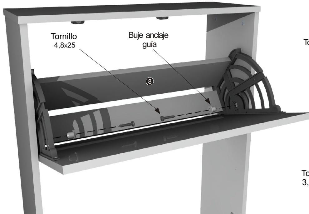
**PASO 7:** Colocar tope de guía y fijarlo mediante tornillo 4x25, luego colocar divisor medio y fijarlo mediante tornillos 3,5x15.
