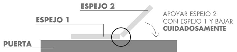
REPETIR PROCEDIMIENTO CON ESPEJO 3 Y ESPEJO 4
